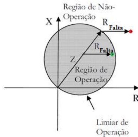
Figura 2.6 – Diferentes curtos resistivos utilizando a característica m\theta (GONÇALVES, 2007).
