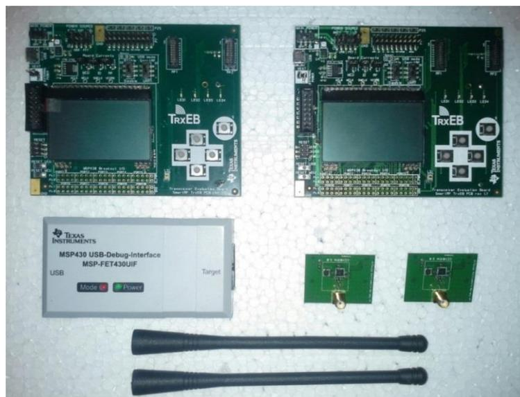
Figura 3.4.3.1 – Placas SmartRF TrxEB (acima), módulos CC1101EMK433 (canto inferior direito), placa de interface e *debug* MSP-FET430UIF (canto inferior esquerdo) e antenas para frequência de 433MHz (abaixo)
