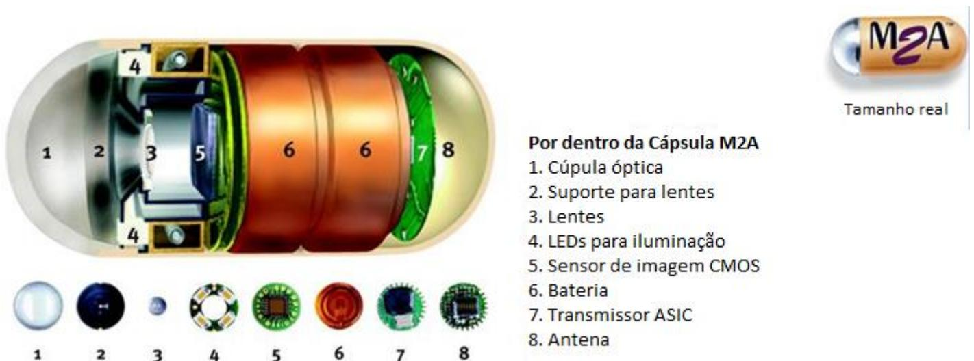
Figura 2.1.1 – Detalhamento da cápsula endoscópica M2A [1]
