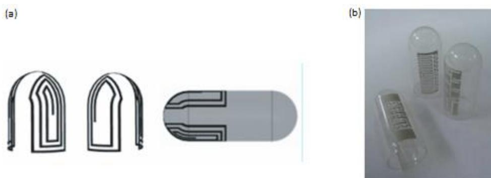
Figura 3.3.2 – Antenas impressas tridimensionais seguindo o formato da cápsula [2]
