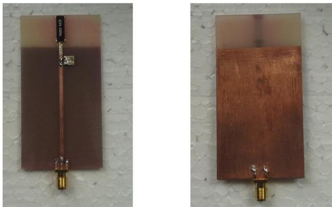
Figura 3.4.2.3 – Fotos da placa de teste confeccionada
