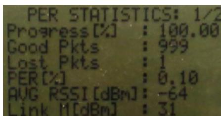
Figura 5.3.1.1 - Medição de PER em condições ideais
