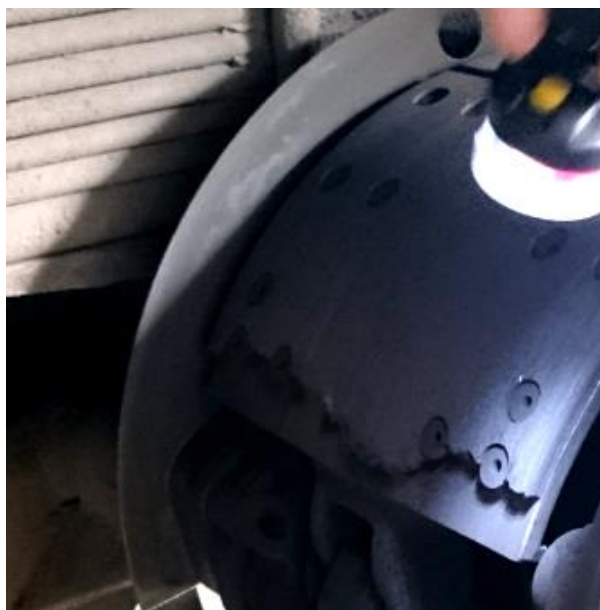
Figura 29 – Perda de material nas lonas.
