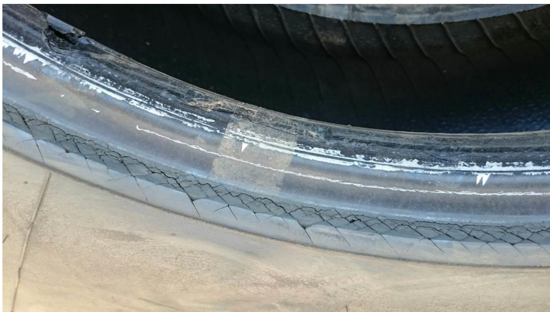
Figura 59 - Tala rachada gerando descarte. [Capuzzo, G. B. M., 2015]
