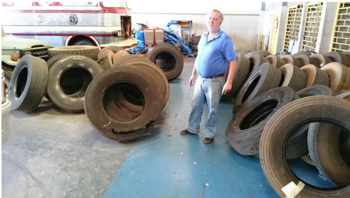
Figura 58 - Pneus: talas rachadas gerando descarte. [Capuzzo, G. B. M., 2015]
