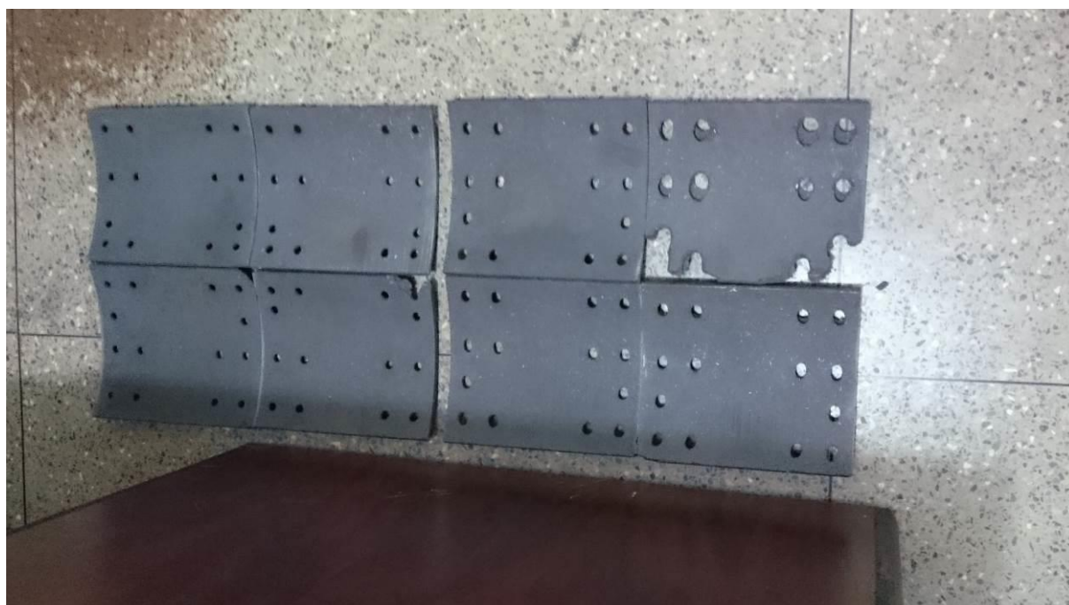
Figura 61 - Desprendimento dos rebites nas lonas de freio. [Malta, J. G., 2015]
