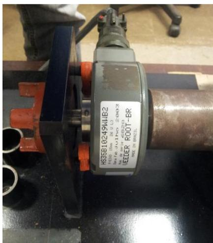
Figura 3.11 - Encoder Incremental (série HS35B1024)
