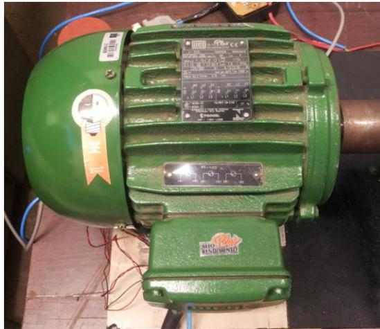
Figura 3.5 - Motor de Indução Trifásico com 2 CV de Potência
