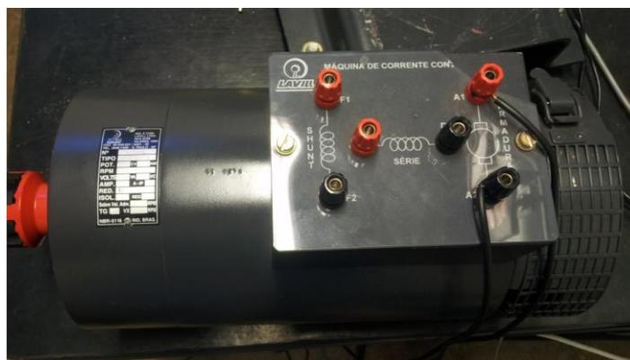
Figura 3.6 - Gerador de Corrente Contínua para Motor de 1 CV
