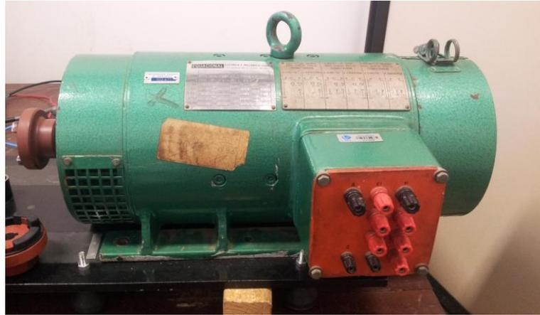
Figura 3.7 - Gerador de Corrente Contínua para Motor de 2 CV
