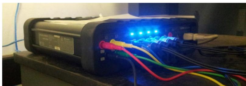
Figura 3.8 - Medidor de Qualidade ELSPEC
