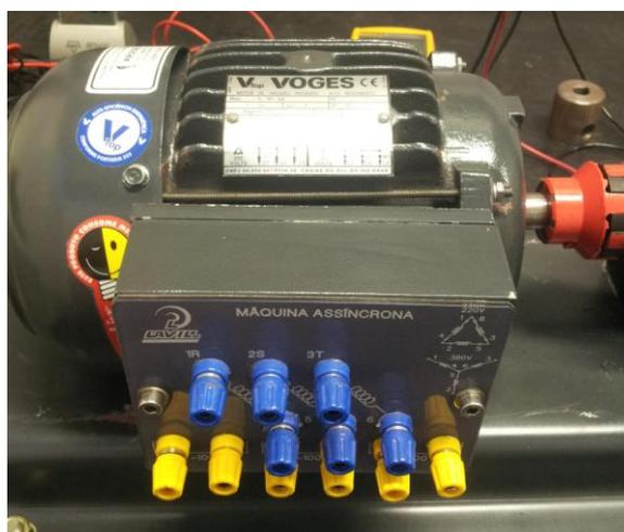
Figura 3.4 - Motor de Indução Trifásico com 1 CV de Potência
