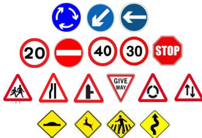
Figura 3.16: Classes de placas de trânsito que o sistema é treinado para reconhecer. Nota-se que a placa “STOP” é detectada como vermelha circular, o que não interfere no reconhecimento desse sinal de trânsito.
