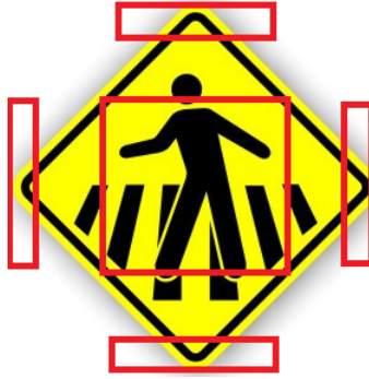
Figura 3.14: Ilustração de como é feita a detecção da forma losangular. Em vermelho, as marcações que indicam as regiões analisadas. Verifica-se que o interior da placa candidata deve ser preenchido com a cor de interesse antes desse teste, pois os pixels pretos podem causar classificações equivocadas de forma.
