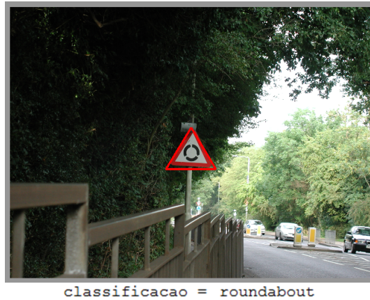
Figura 4.7: Detecção e reconhecimento de uma placa vermelha triangular. Há a indicação da cor e da forma no local onde a placa foi detectada. Na parte de baixo está a classificação feita pelo sistema. A imagem original é do banco Cloudy .
