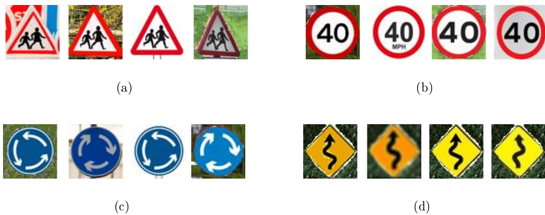
Figura 3.15: Algumas das placas de treinamento das SVM's. (a) Sinais vermelhos triangulares ( Pedestrian ). (b) Placas vermelhas circulares ( Zone 40 ). (c) Placas azuis circulares ( Mini Roundabout ). (d) Sinais amarelos losangulares de treinamento ( Pista Sinuosa ).
