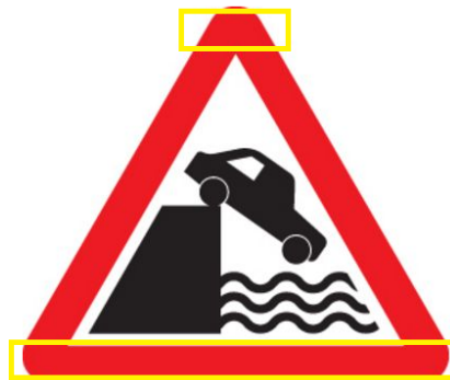
Figura 3.13: Ilustração da análise complementar que o sistema faz para confirmar a suspeita de que um sinal de trânsito é de fato triangular. Em amarelo, as indicações aproximadas das linhas superiores e inferiores que são usadas para o teste de proporcionalidade.
