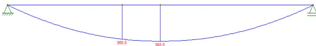
Figura 42-Momento máximo na seção estudada (kN.m).
