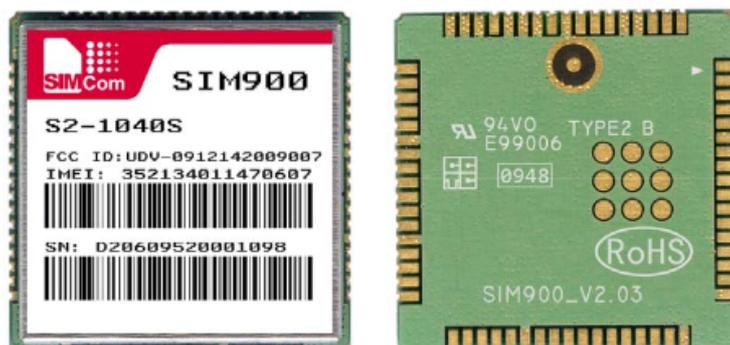
**Figura 7 Chip SIM900 - Módulo GSM/GPRS**
