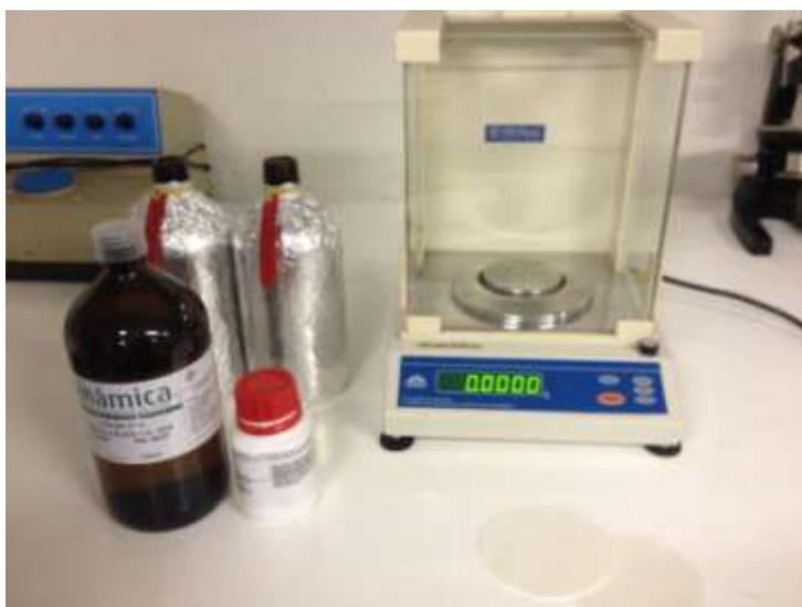
**Figura 1** – Balança de precisão, ácido indolbutírico, álcool absoluto e frascos e utilizados no preparo das soluções de AIB (Estação Experimental de Biologia – EEB, Universidade de Brasília-UnB, 2015).
