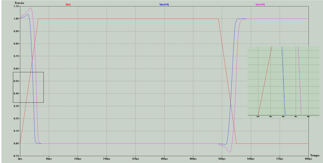
Figura 4.1: Entrada e saída do primeiro ciclo da fonte nos registros de 16nm e 45nm com detalhe ampliado.
