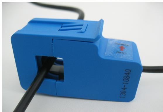
Figura 4.20: Acoplamento magnético entre o sensor de corrente e o condutor.
