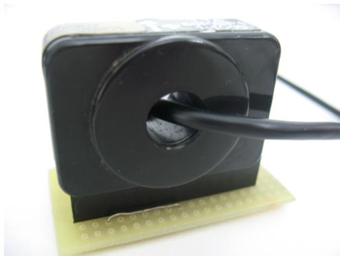
Figura 4.21: Acoplamento magnético entre o sensor de efeito Hall e o condutor.
