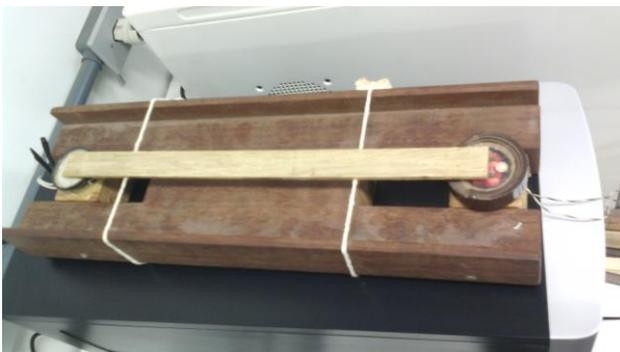
Figura 5. Anteparo de madeira proposto para teste de vibração forçada proposto por Hearmon (1965).
