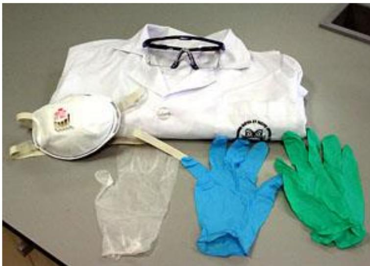
Figura 31. EPIs necessários para o uso do laboratório. Fonte: Universidade Fernando Pessoa (<http://cela.ufp.pt/CD/seguranca-equipamento.htm>)
