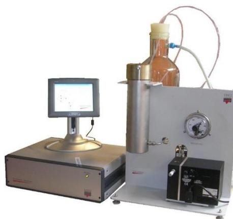
Figura 17. Equipamento de Saturação Automático. Fonte: <http://www.vinci-technologies.com/products-explo.aspx?IDR=82293&idr2=82576&idp=82288&IDM=536821>
