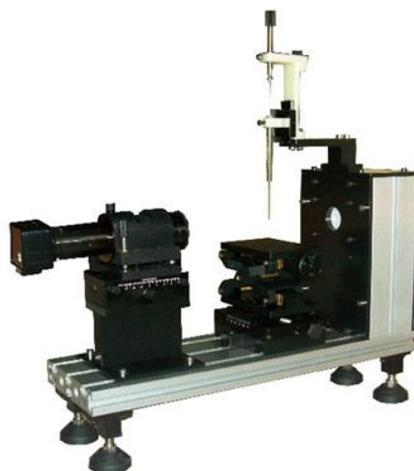
Figura 20. Goniômetro para medição do ângulo de contato. Fonte: United Test.
