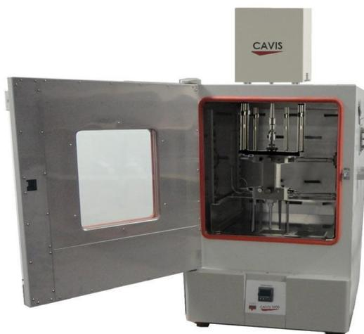
Figura 25. CAVIS (Viscosímetro Capilar).
