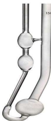
Figura 24. Viscosímetro de Cannon-Fenske. Fonte:
