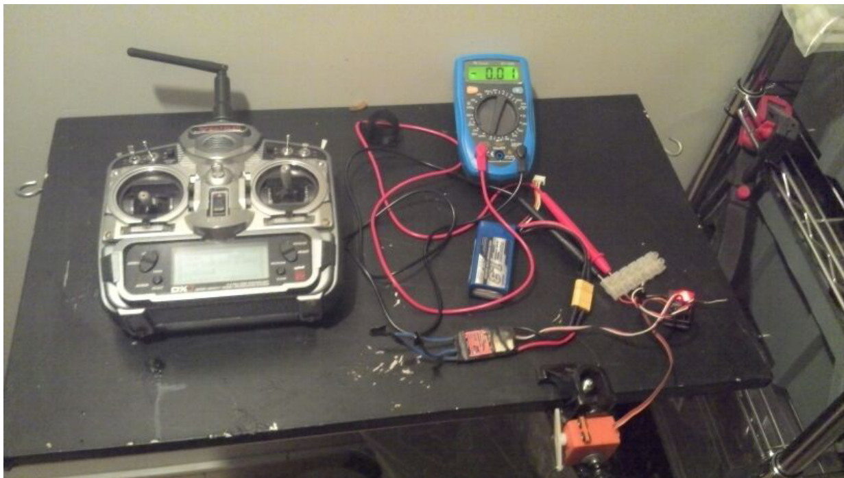
Figura 3.11: Teste em Servos Para Cálculo de Corrente de Travamento.
