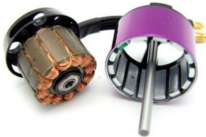
Figura 2.14: Detalhe de um Motor brushless Internamente [HobbyKing 2013].
