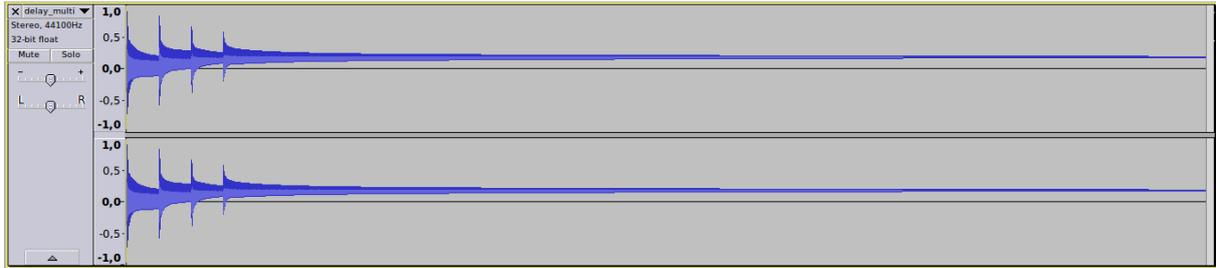
Figura 5.4: Onda gerada pela aplicação do efeito de delay múltiplo. Para esta onda, os parâmetros seleccionados foram: 0.3 segundos de atraso, 0.7 de atenuação e 3 repetições
