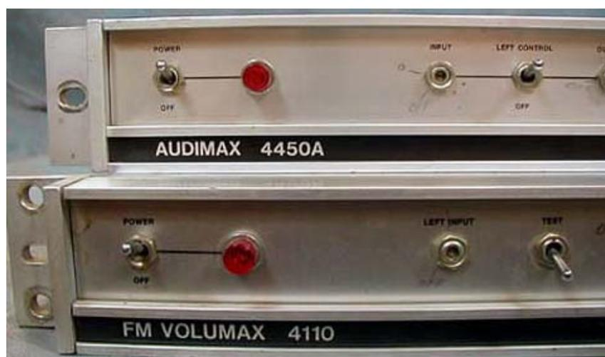
Figura 3.2: Volumax 4450A e Audimax, dos Laboratórios CBS, equipamentos utilizados para estabilização e melhora do sinal de rádio no período do seu surgimento
