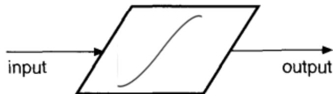
Figura 4.9: Circuito que implementa um efeito de distorção simplificado. Aqui, o sinal de entrada passa pela função de modelamento, gerando como sinal de saída o sinal distorcido.
