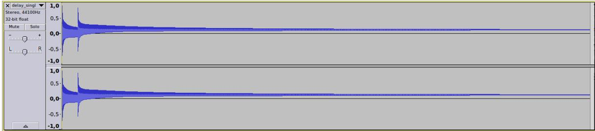
Figura 5.2: Onda gerada pelo opcode *pluck* do Csound e processada pelo efeito de delay simples descrito no capítulo anterior. Os parâmetros do efeito foram: 0.3 segundos de atraso e 0.7 de atenuação.
