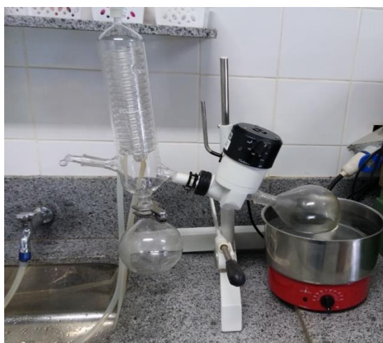
Figura 3. Rotoevaporador montado para a destilação de gasolina. Escala 1:7.
