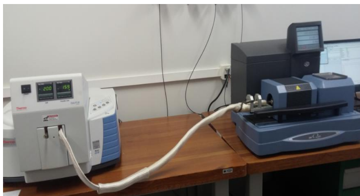
Figura 4. Equipamentos de TGA/DSC e FTIR acoplados no laboratório da FGA. Escala 1:9.
