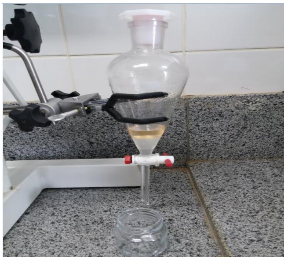
Figura 2. Funil de separação com as fases de gasolina e da mistura etanol-água. Escala 2:5.
