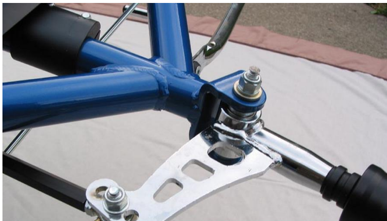
Figura 15 Sistema de Direção e alinhamento manga de eixo. (Carros Infoco, 2015)
