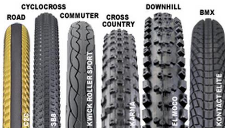
Figura 17 Tipos de pneus segundo sua aplicação (Podium, 2015)
