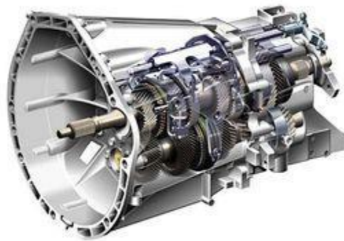
Figura 32 Caixa de marchas com trocas manuais (How Stuff Works, 2015).
