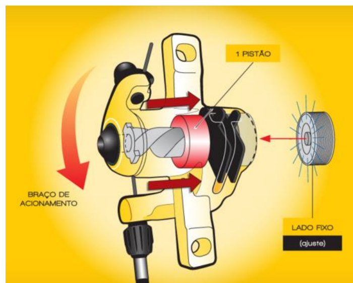
Figura 48 Funcionamento de uma pinça de freio a disco mecânica (Pedaleira, 2015).
