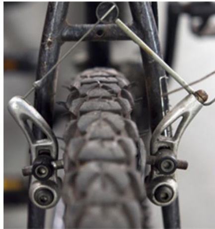
Figura 44 Freio do tipo cantilever (Revista Bicicleta, 2012).
