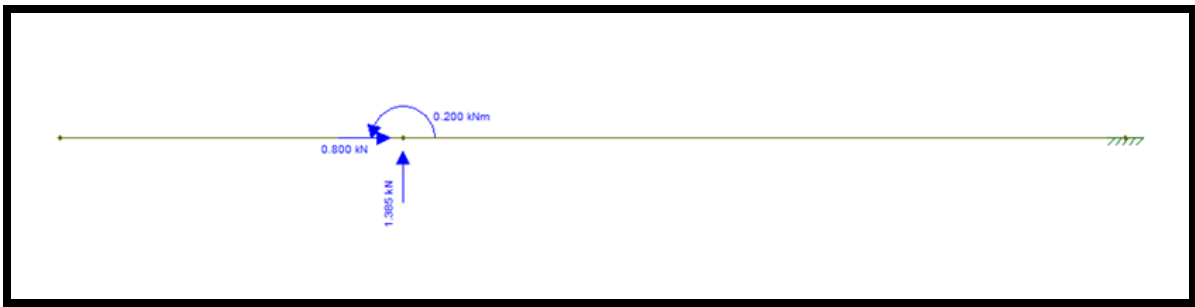
Figura 121 Diagrama de corpo livre, eixo dianteiro, plano xy.
