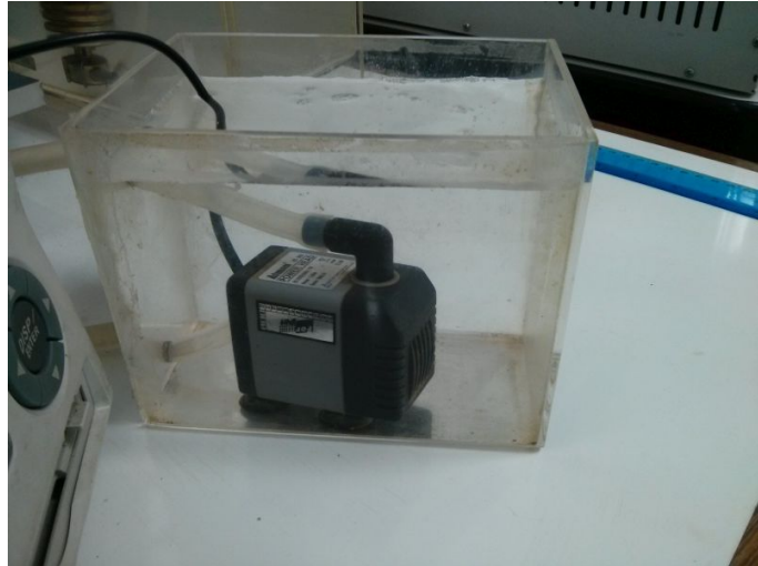
(b) Bomba de circulação
