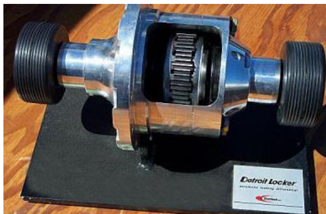
Figura 2.3. 2. Detroit Locker, tipo mais comum de diferencial bloqueável automático. (OffRoaders)
