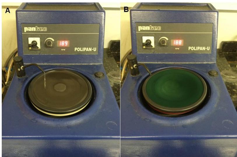
Figura 2 – Equipamento politriz (Poliplan U, Pantec, São Bernardo, Brasil); A – lixas metalográficas; B – disco de feltro
