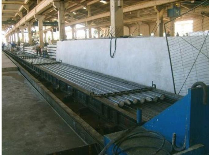
Figura 2.17. Posicionamento dos moldes dos vazios das Lajes Alveolares (fonte: MIGLIORE, Gabriel, Dimensionamento e utilização de laje alveolar protendida)
