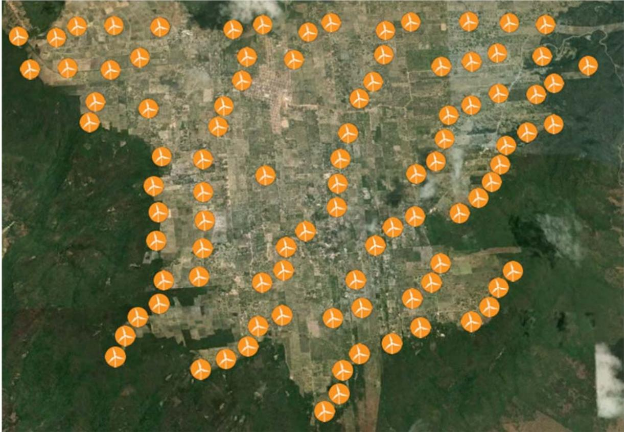
Figura 4.19 Layout do parque eólico de 96 turbinas modelo C97 2000 kW com torres de 78 metros.
