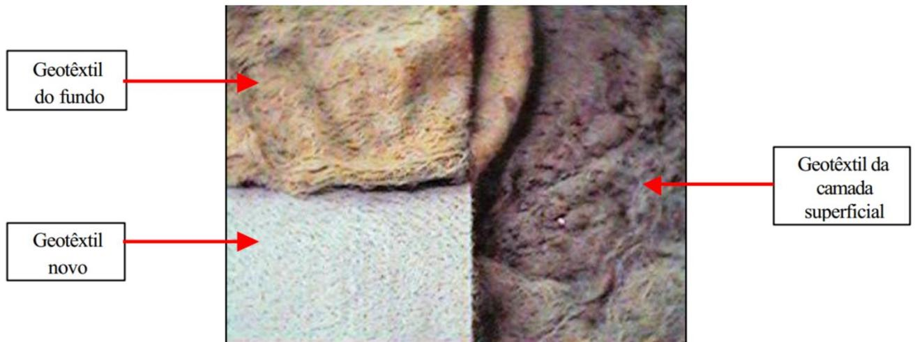
Figura 2.3 – Condições do geotêtil no interior da trincheira após 33 meses de utilização.
