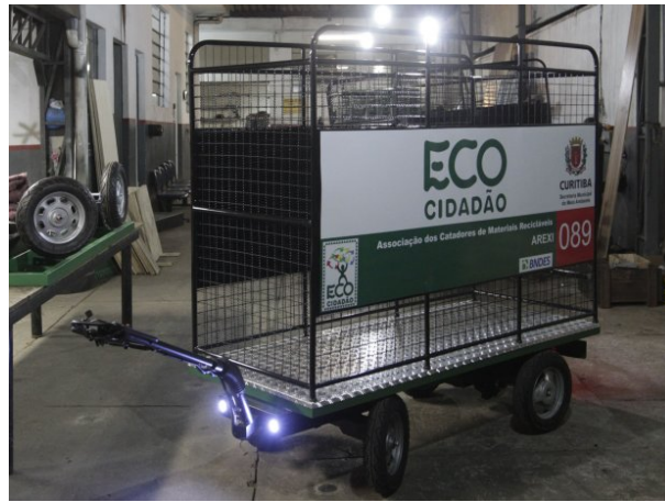
Figura 6.4 – Modelo de carrinho elétrico utilizado para coleta de resíduos sólidos
