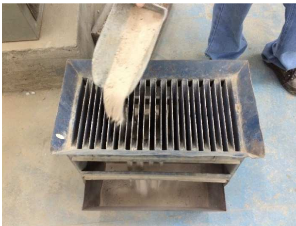
Figura 7.10 – Separação da amostra pelo Método “A” da NBR NM 27/2001.
