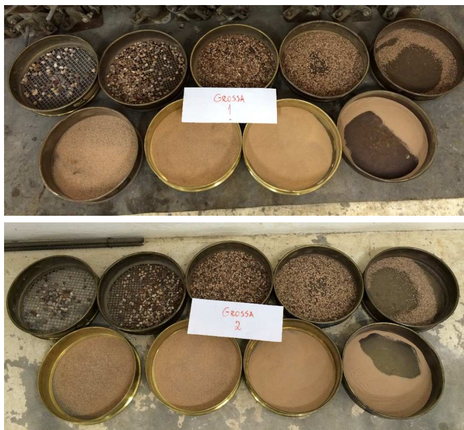
Figura 7.18 – Material retido em cada peneira (areia grossa).
