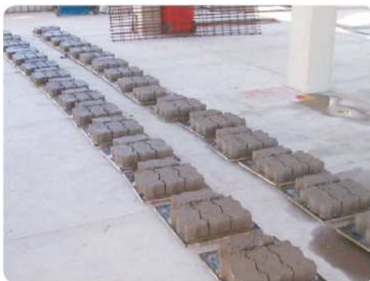
2.26 – Confeção de pavers com agregados reciclados (Lima e Lima – S.D.).
