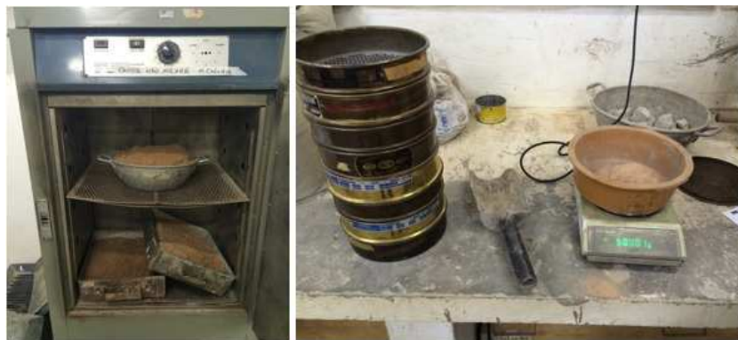
Figura 7.13 – Secagem e pesagem da areia fina.
