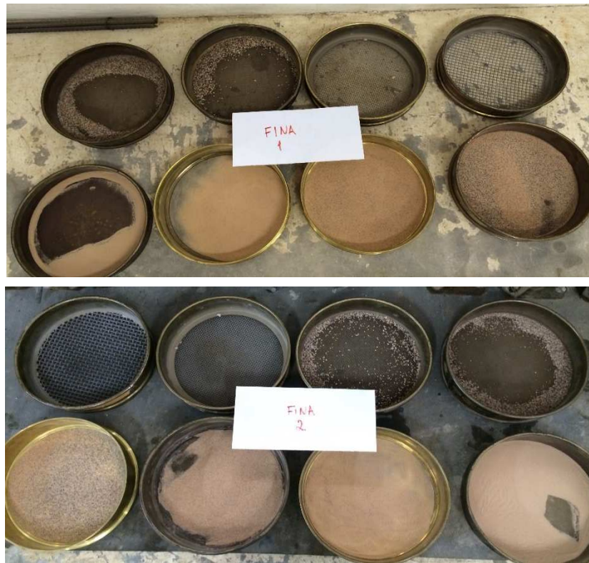
Figura 7.14 – Material retido em cada peneira (areia fina).
