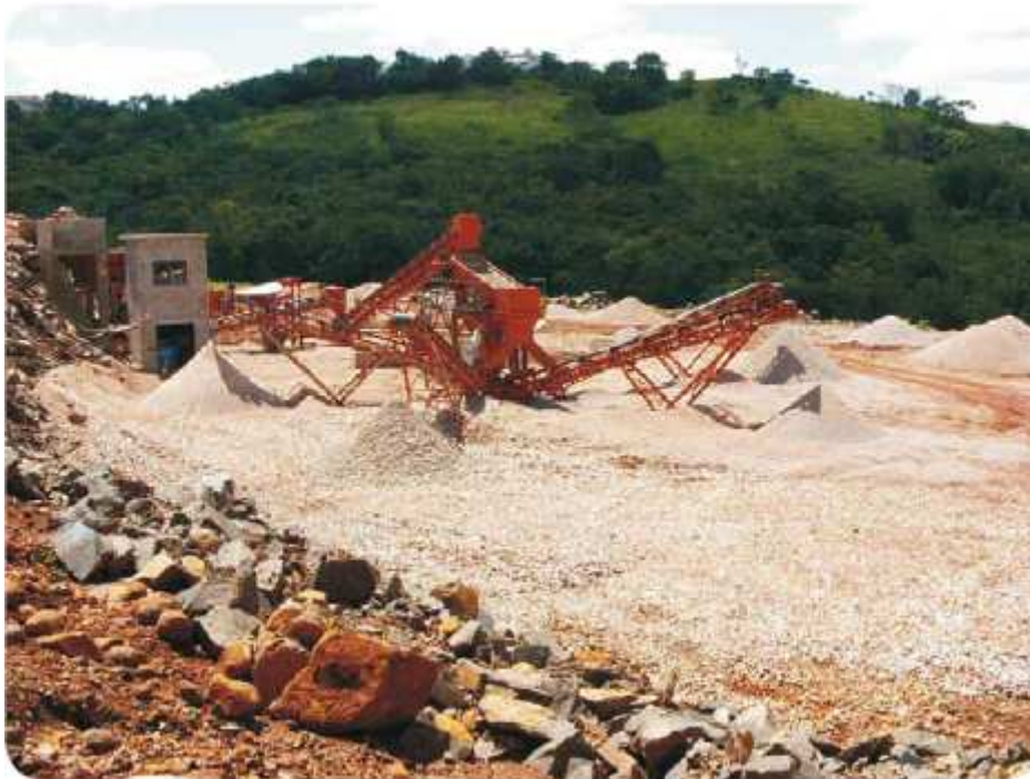
2.28 – Usina de reciclagem de concreto (Lima e Lima – S.D.).
