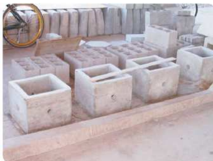
2.27 – Confeção de caixas de gordura com agregados reciclados (Lima e Lima – S.D.).
