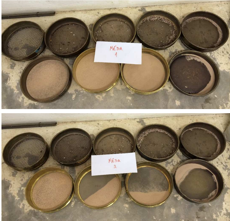
Figura 7.16 – Material retido em cada peneira (areia média).
