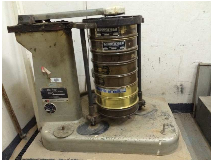
Figura 7.12 – Peneiras e agitador mecânico utilizados.
