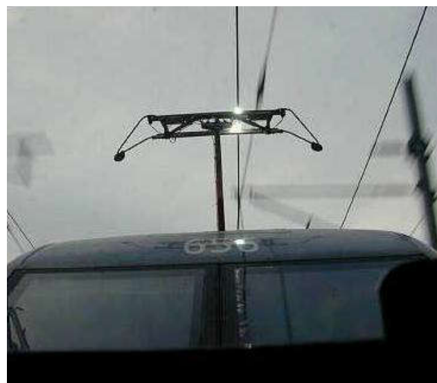
Figura 2.2. Pantógrafo a deslizar ao longo do fio de contato, de COSTA (2009).
