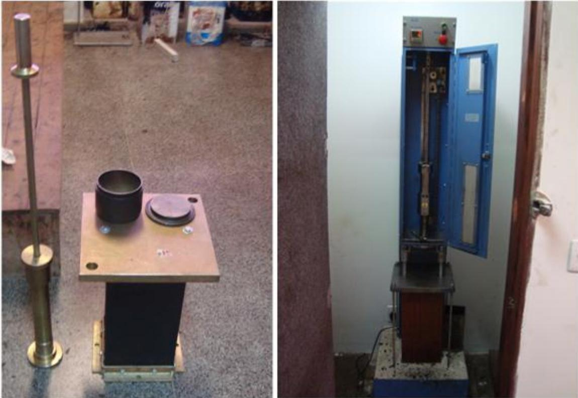
Figura 4-3 a) compactador manual com molde Marshall; b) compactador mecânico
