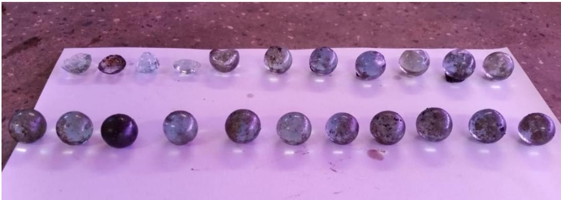
Figura 4-1 – Condição das bolinhas de Gude no CP3 após ensaio de Fluência
