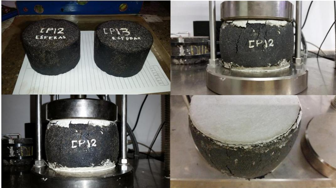
Figura 5-12 – Corpos de Prova antes do ensaio (superior esquerda) e CP12 após o ensaio de fluência
