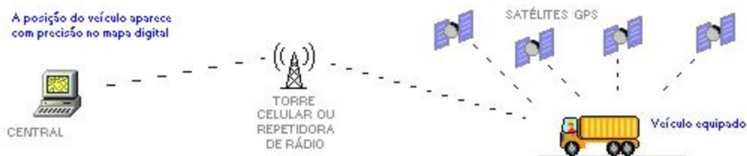
Figura 2.4- Funcionamento do GPS
