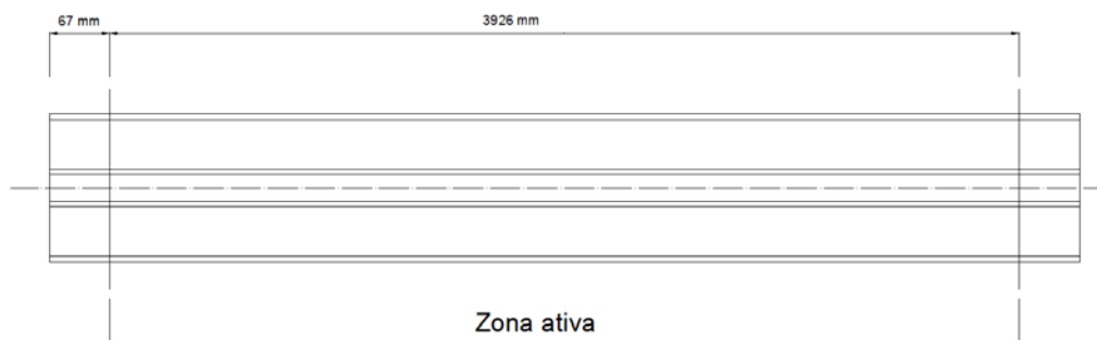
Figura 26. Esquema da parte ativa do tubo absorvedor.
