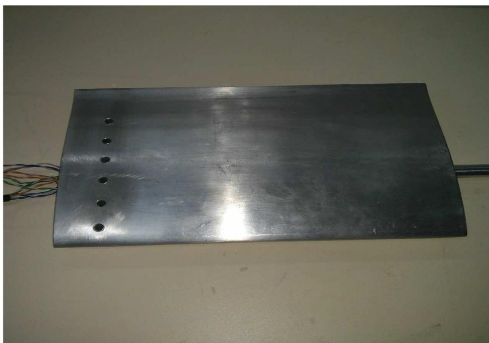
Figura 1.3: Eletreto instalados em perfil aerodinâmico.
