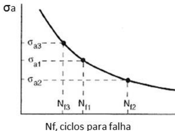
Figura 2.12 - Curva S-N (Dowling, 2007).
