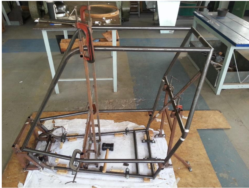
Figura 4.4 – Gaiola em construção.
