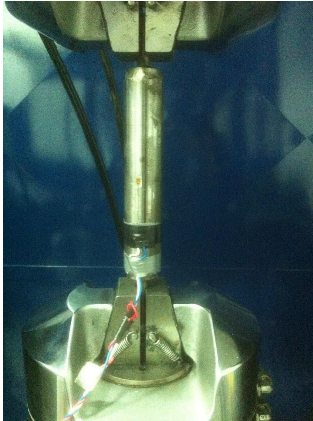
Figura 5.34 – Corpo de prova instrumentado e posicionado na MTS 810.
