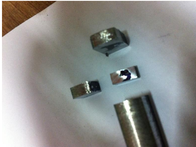
Figura 3-1 Corte das amostras nas três direções para o embutimento
