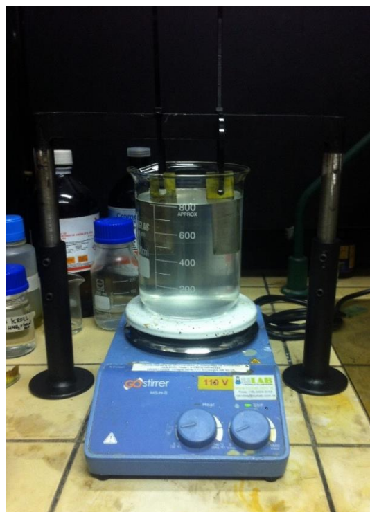
Figura 4-10 Ensaio de corrosão montado
