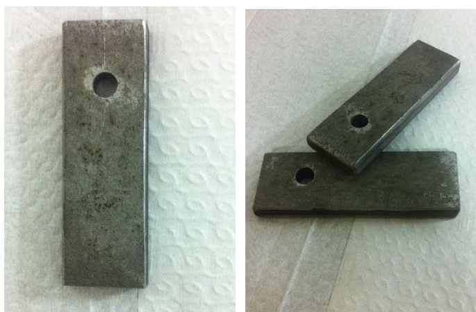
Figura 3-4 Amostras para ensaio de corrosão
