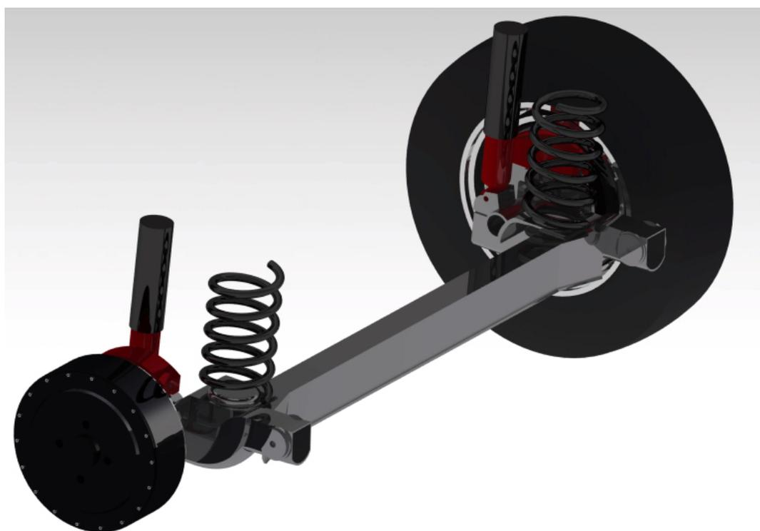
Figura 34 – Modelo CAD apresentando o eixo com o ME em destaque.
