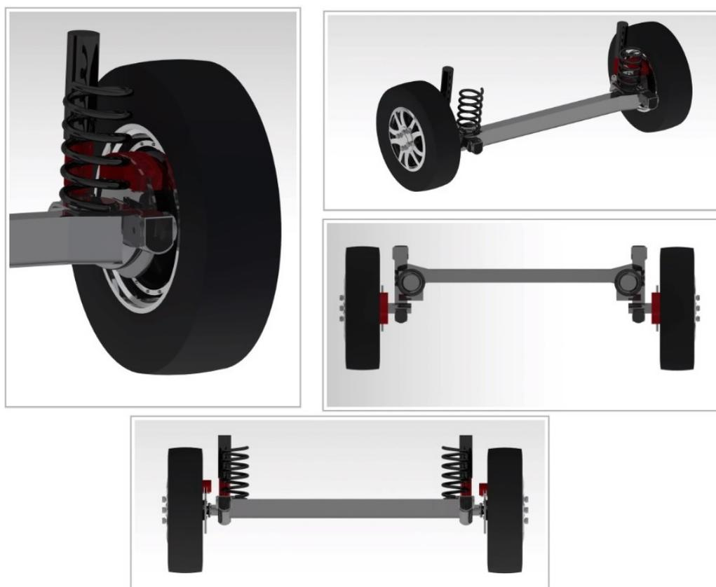
Figura 33 – Modelo CAD apresentando a proposta do VHE com ME nos cubos de rodas.
