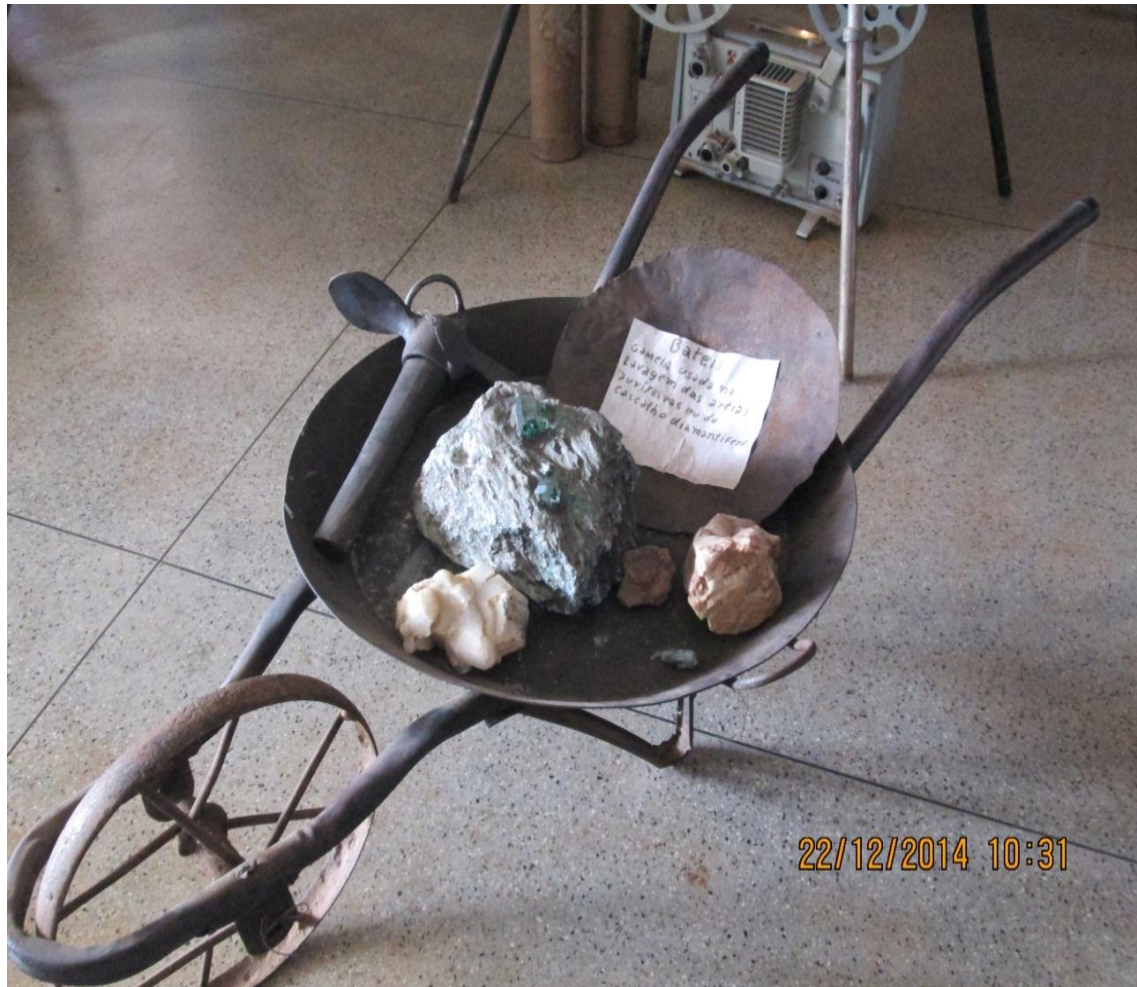
Figura 05: Bateia, Gamela usada na lavagem das areias para retirada do ouro.
