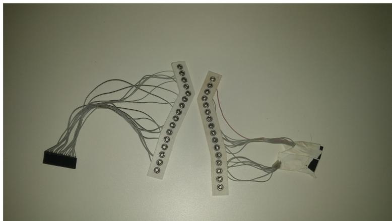
Figura 19 – Eletrodos desenvolvidos para o músculo gastrocnêmio cabeça medial à esquerda e cabeça lateral à direita
