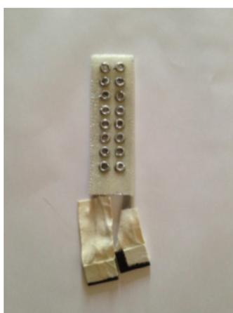
Figura 26 – Arranjo linear de 16 eletrodos com distância intereletródica de 10 mm desenvolvido por Silva (7)
