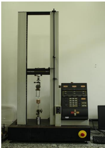
Figura 1 – Máquina INSTRON 4411, utilizada para a realização do teste de tração das amostras
