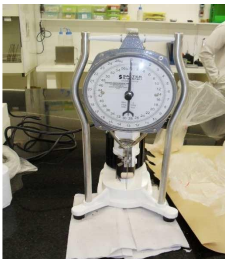
Figura 6. Aparelho Warner-Bratzler utilizado para avaliar a força de cisalhamento. pessoal Fonte: Dannielle Migotto
