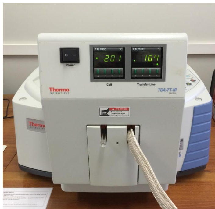
Figura 6 - Equipamentos acoplados: Interface Thermo Scientific TGA/FTIR e Espectrofotômetro Nicolet IS10.
