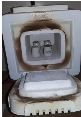
Figura 19. Procedimento de preparação dos substratos; Aplicação do material com pincel no substrato de alumina (a); Forno com os substratos (b).
