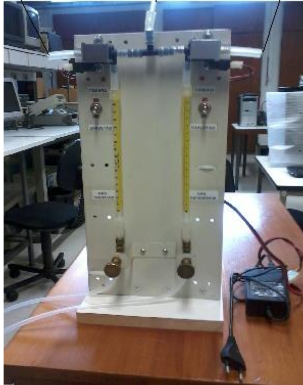
Figura 21. Sistema de injeção de gases.
