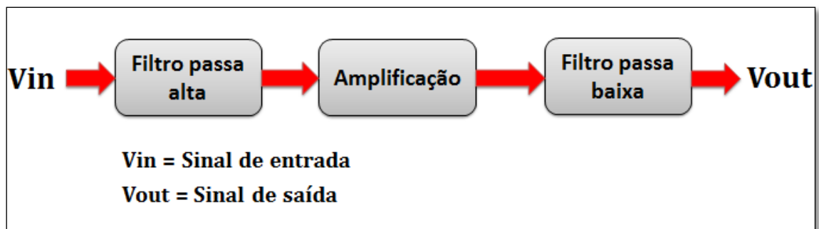
Figura 17. Diagrama de blocos de um filtro ativo passa faixa.
