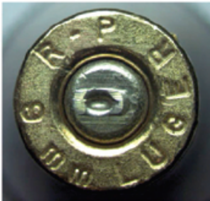
Figura 5. Marcas do pino percursor e ferrolho. [1]
