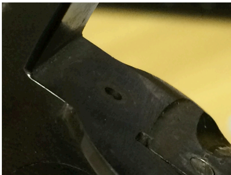
Figura 4. Ferrolho e furo passante do pino percussor.
