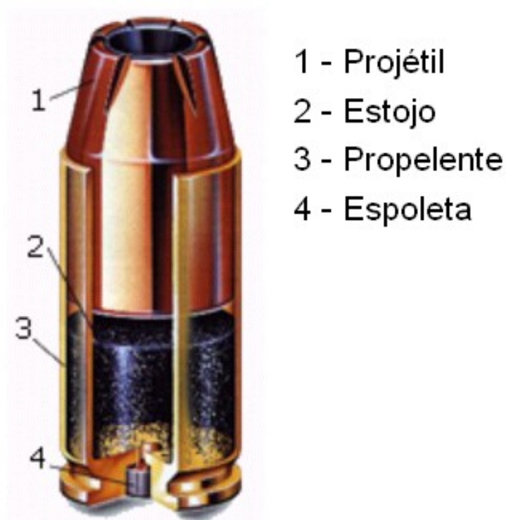
Figura 1. Partes de uma munição. [2]
