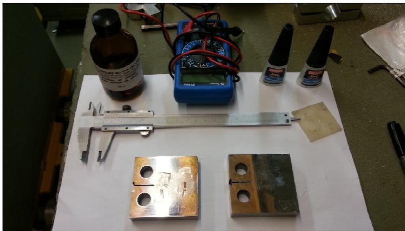
Figura 59- Materiais utilizados para colagem dos extensômetros no CP.
