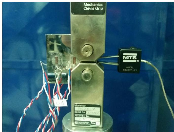
Figura 10 - Corpo de ensaio do tipo C(T) com o clip gage fixado na boca do entalhe.
