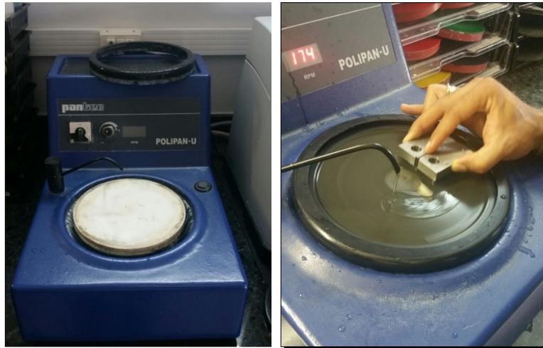
Figura 37– a) Equipamento para o processo de lixamento. b) Corpo de prova sendo lixado.
