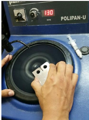
*Figura 38-- Processo de Polimento do corpo de prova*
