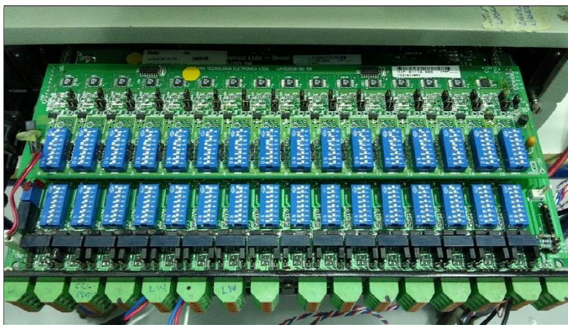
Figura 65 - Indicação das resistências para Shunt na placa 1 do ADS.
