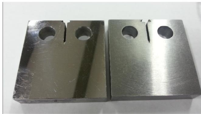
*Figura 39 - a) Corpo de prova polido. b) corpo de prova não-polido.*
