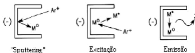
**Figura 9** - Processo de emissão de elétrons da lâmpada de cátodo oco. <sup>53</sup>
