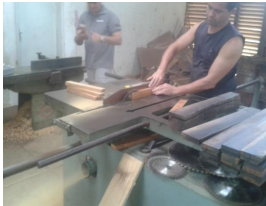
Figura 3: Cortes dos sarrafos em serra circular
