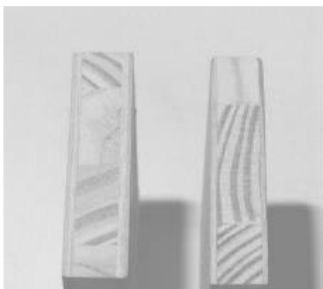
Figura 2 – Corte transversal de uma amostra de compensado sarrafeado
