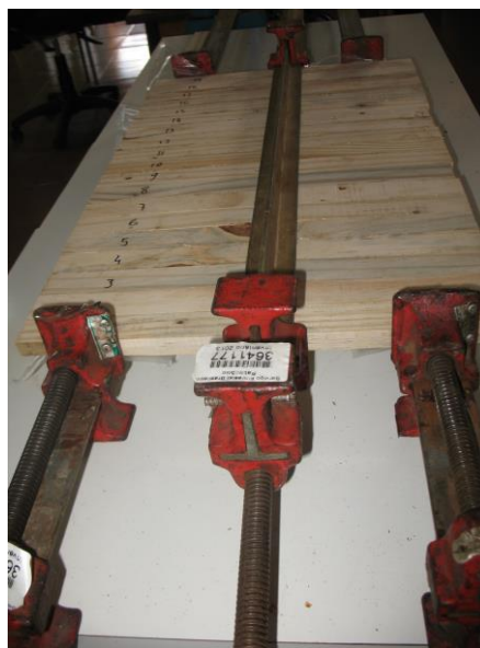
Figura 5: Procedimento de prensagem com grampos
