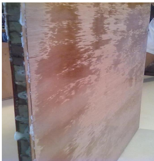
Figura 6 – Compensado Sarrafeado de dimensões 340mm x 560 x 15mm
