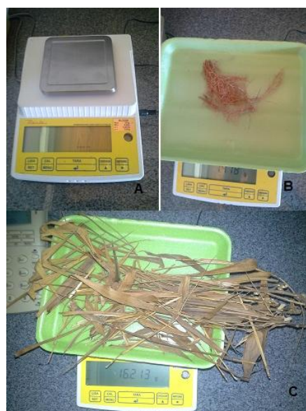
Figura 6- Determinação da massa seca. A: Balança eletrônica; B: Raízes em recipiente para pesagem; C: Parte aérea em recipiente para pesagem.
