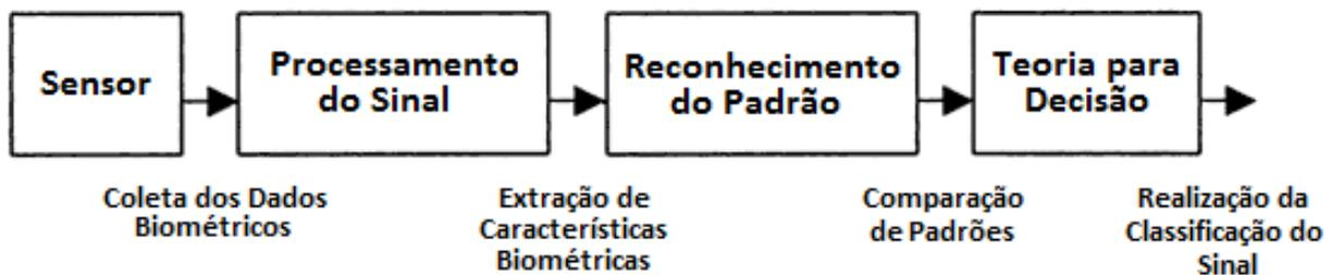
Figura 2.5: Procedimentos gerais de um sistema biométrico genérico com quatro etapas de processamento (adaptada de [43]).
