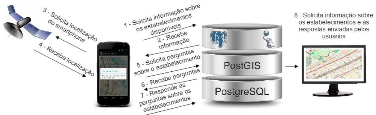
Figura 3.2: Funcionamento da Arquitetura.
