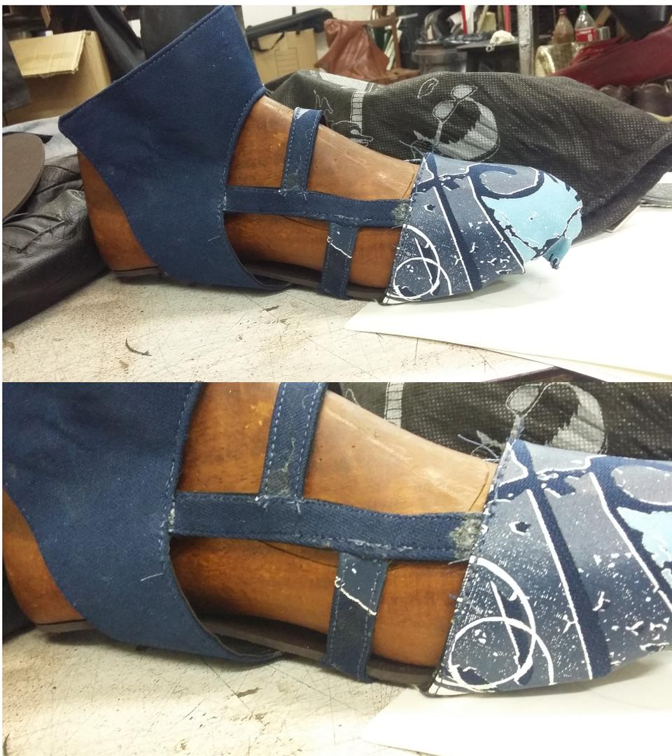
Figura 43 – Primeiro protótipo e erros de acabamento
