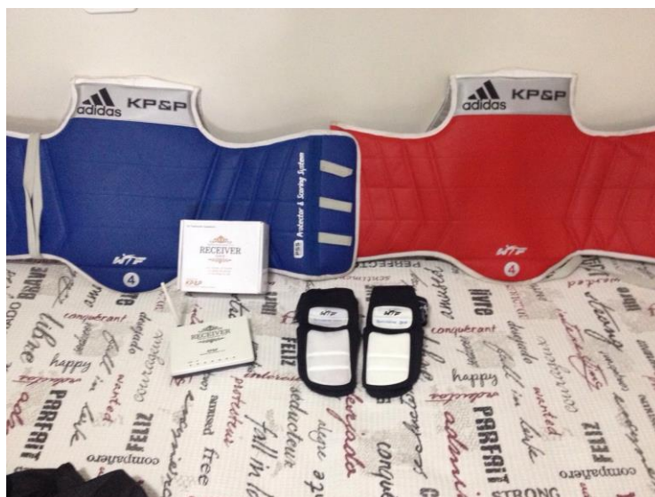
Figura 3 - Protetor eletrônico (acima - vermelho e azul) e meias abaixo dos protetores (preta com branco) KP&P e aparelho wireless de conexão dos protetores ao computador (abaixo do protetor azul - Receiver)
