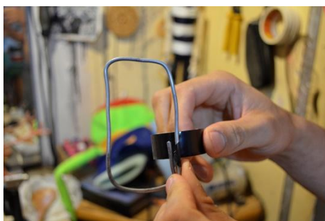
Figura 111 – fixação do gancho com fita isolante
