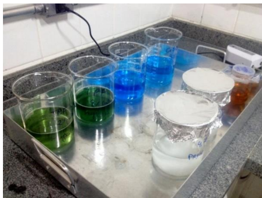
Figura 4. Tratamentos químicos: TBF a 2% e 4% (incolor), Bórax a 3% e 4,7% (cor verde) e Sulfato de cobre a 3,5% e 5% (cor azul).
