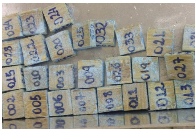
Figura 7. Corpos de prova de Bambusa vulgaris tratadas com Sulfato de Cobre.
